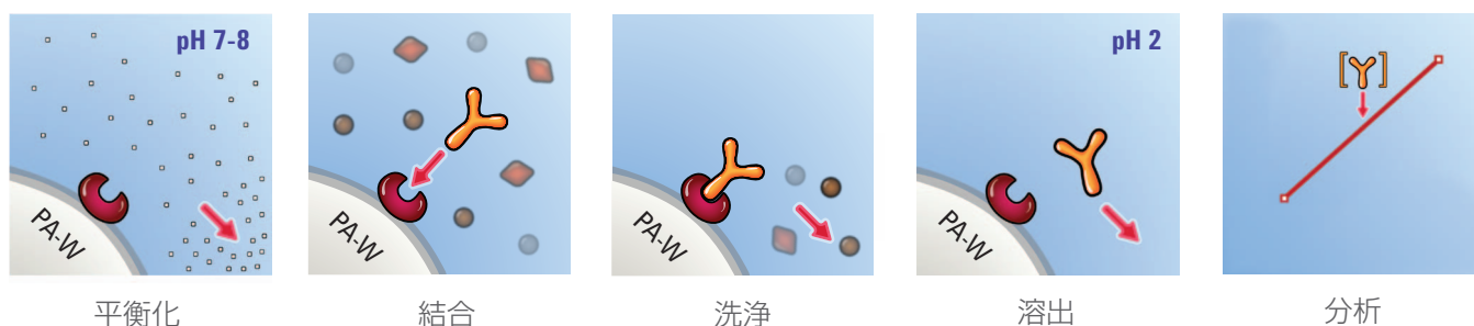
図 1. AssayMAP プロテイン A カートリッジを備えた Agilent Bravo タンパク質精製用システムのワークフロー。タンパク質力価分析に使用する場合。プロテイン A が中性 pH で mAb を捕捉し、その後、低 pH の酸性バッファで mAb を溶出します。検量線を作成し、バイオリアクターで生成された mAb の濃度を正確に測定することができます。
