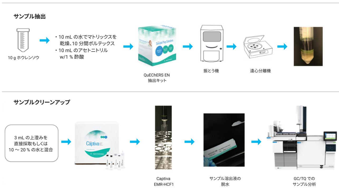
図 1. 従来の Agilent QuEChERS 抽出、その後の Agilent Captiva EMR-HCF1 または HCF2 パススルークリーンアップを含む、サンプル前処理のフローチャート<sup>1</sup>
