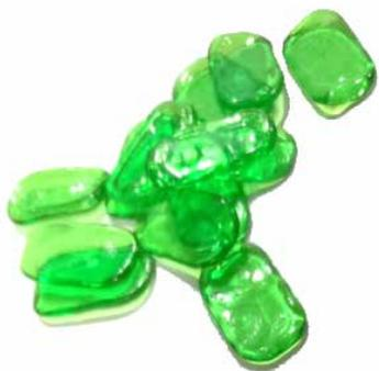
図 1. キャリブレーション標準の準備に使用した空のソフトゲルカプセル
