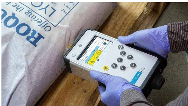
図 1. 倉庫で袋内の材料を同定するのに使用する Agilent Vaya ラマンシステムハンドヘルド分光装置
