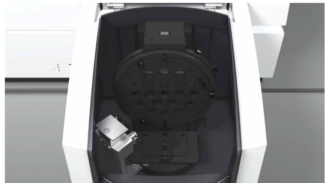
図 1a. ソリッドオートサンブラを取り付けた Cary 7000 UMS 測定チャンバーを上から見た画像
