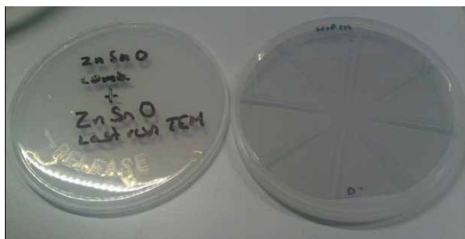
図 2a. Zn/Sn でコーティングされた直径 100 mm (4 インチ) のサファイア基板
