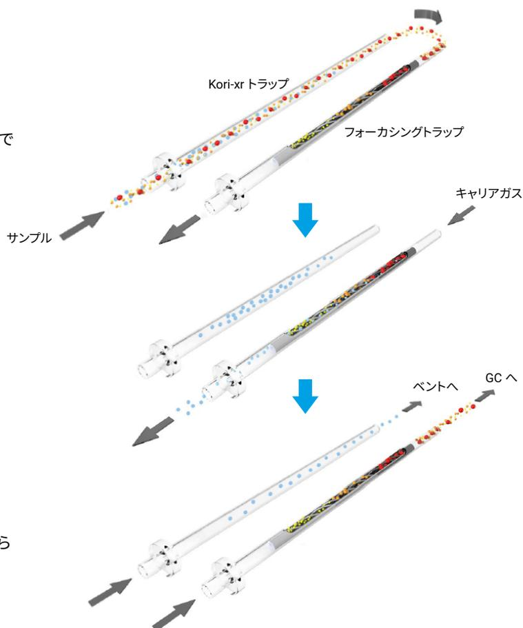
図 2. 概略図は Dry Focus3 の全プロセスを示しています。
