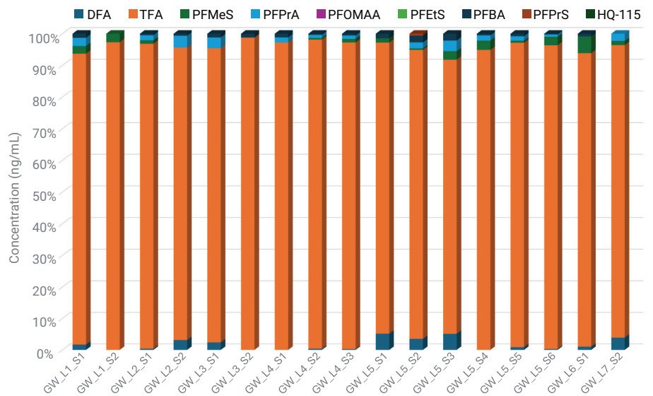
図 5. 埋立地のモニタリング井戸からの地下水サンプルの結果。埋立地は、LX とその後の現場番号で示されています。
