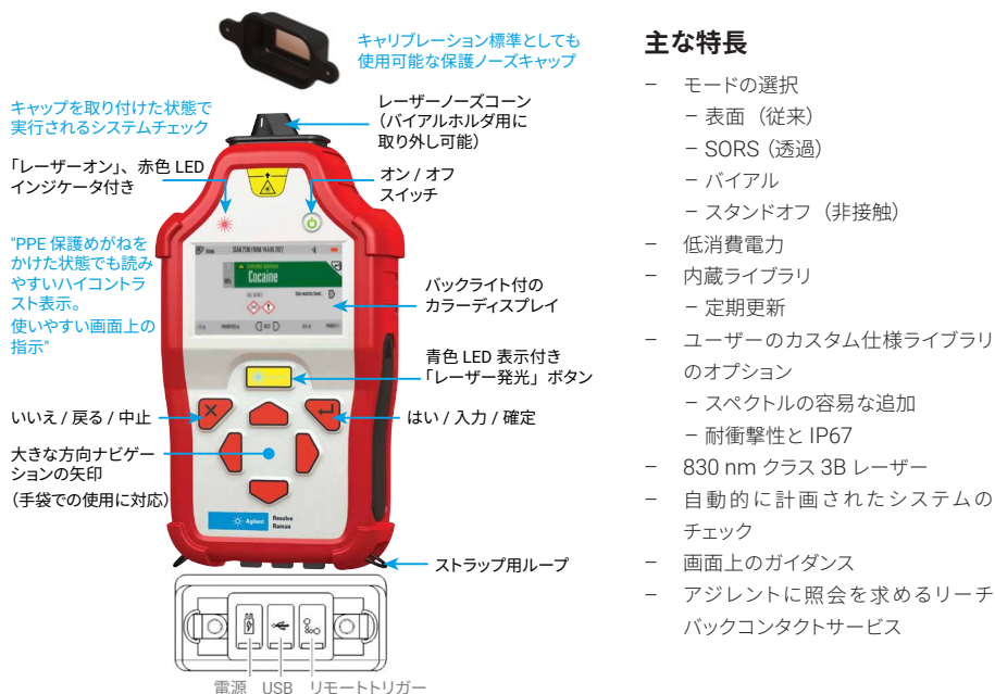
図 1. Agilent Resolve ハンドヘルド型ラマンアナライザの概略図
