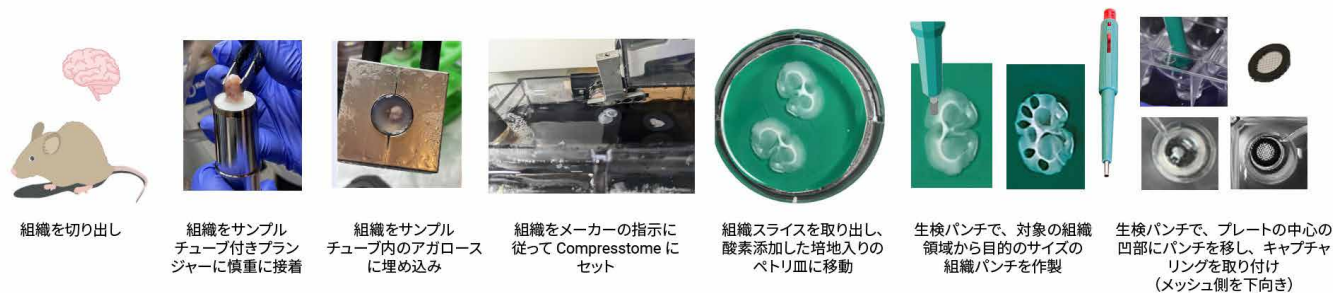
図 2. Precisionary Instruments 社の Compresstome を使用した、ラット脳組織スライズの準備に必要な主な手順の概略図
