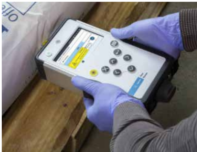
図 2. Agilent Vaya Raman ハンドヘルド分光装置は、通常 3 層の紙と PE ライナで構成される紙袋内の材料を同定するために使用されます。
