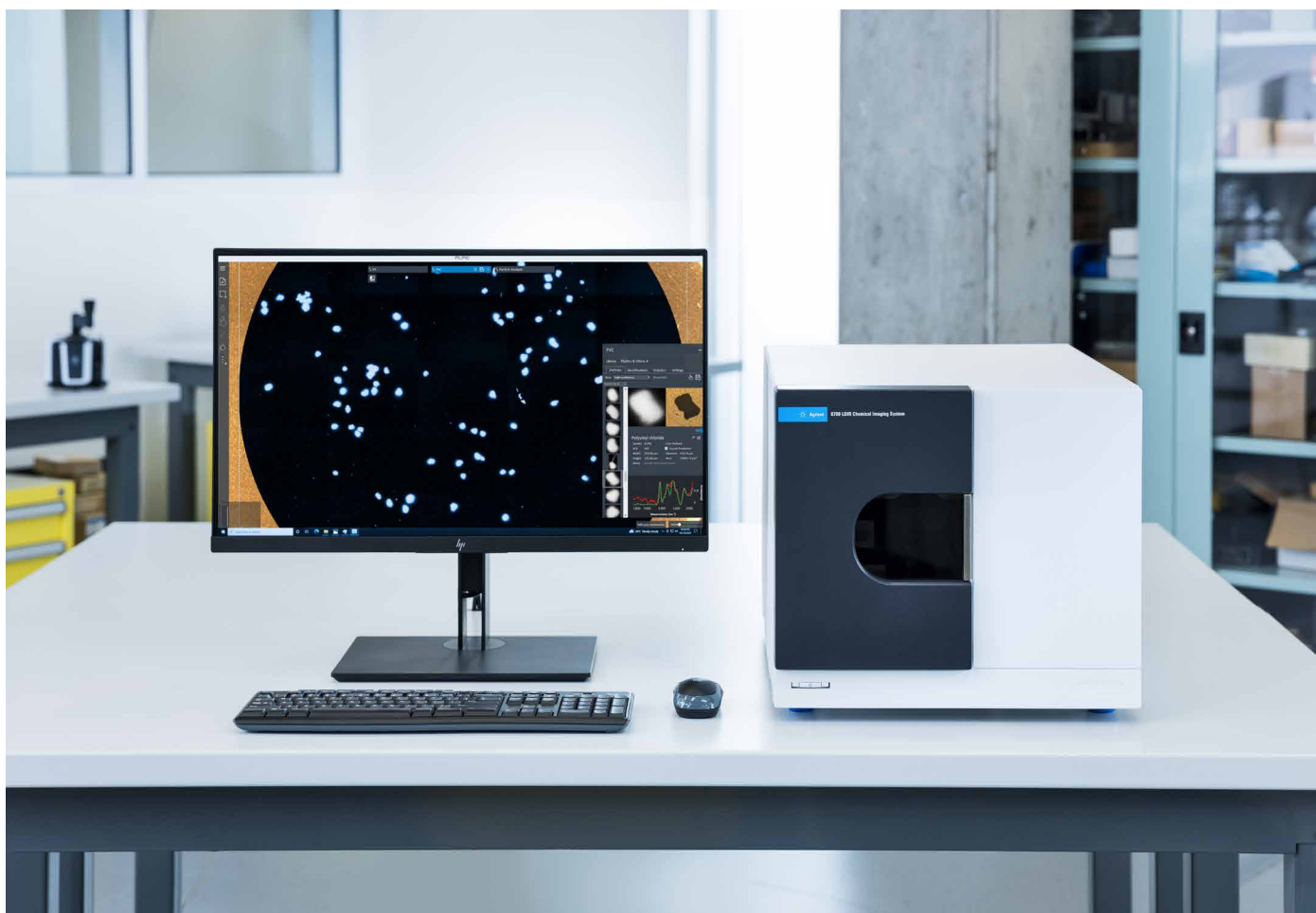
図 1. Agilent Clarity ソフトウェアを搭載した Agilent 8700 LDIR ケミカルイメージングシステムにより、粉末サンプル中の粒子の数、サイズ、化学組成など、粒子の高速ルーチン分析が可能になります。
