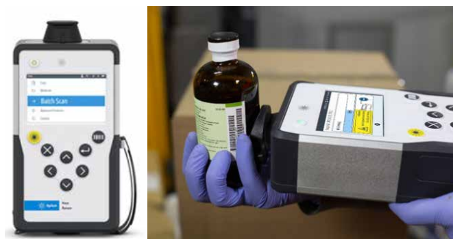
図 1. SORS 技術搭載の Agilent Vaya ラマンハンドヘルド分光装置を使用して、褐色瓶越しに材料/溶媒を同定している様子
