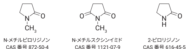
図 1. N-メチルピロリジノン（NMP）、N-メチルスクシンイミド（NMS）、2-ピロリジノン（2PYR）の構造と CAS 番号
