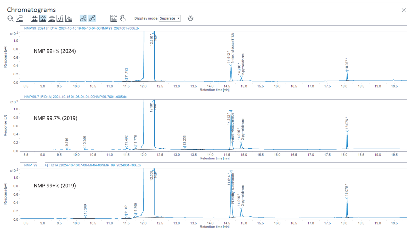
図 3. Agilent J&W DB-23 カラムで分析した市販溶媒の正規化したクロマトグラム
