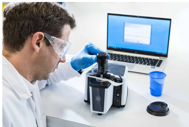
図 2. ダイヤモンド減衰全反射（ATR）モジュールを備えた Agilent Cary 630 FTIR 分光光度計
