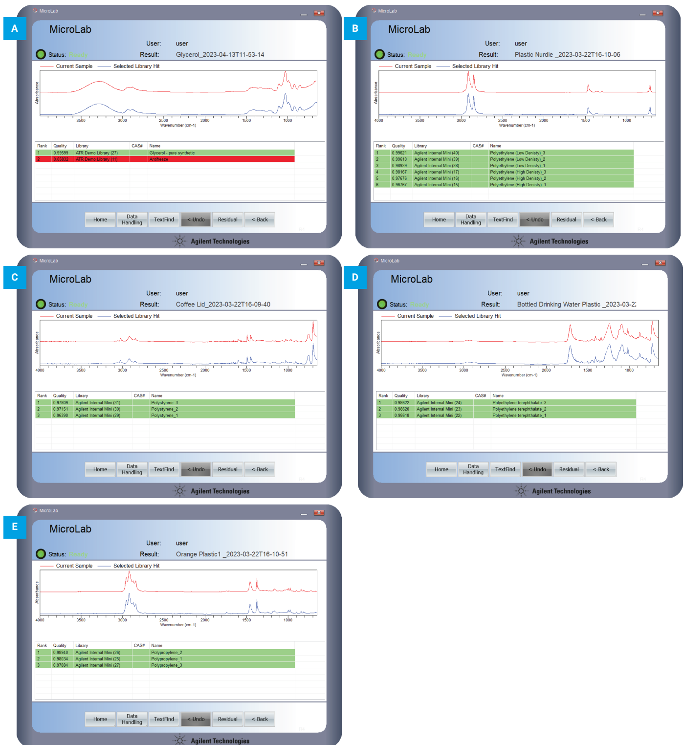
図 4. Agilent Cary 630 FTIR 分光光度計による 5 つのプラスチックサンプル（赤のトレース）とライブラリヒット（青のトレース）の定性分析。この表は、ヒットクオリティ、使用したライブラリ、各サンプルのヒット名 (A) 可塑剤、(B) ナードル、(C) コーヒーの蓋 (D)、水ボトル (E)、風化プラスチックを示したものです。
