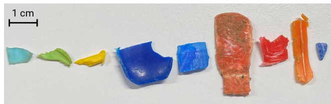
図 2. 本検討で、オーストラリアのビーチから収集し、Agilent Cary 630 FTIR を使用して分析したプラスチック片
