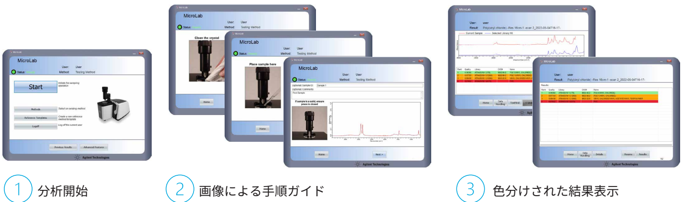
図 4. 直感的な Agilent MicroLab ソフトウェアのワークフローにより、Agilent Cary 630 FTIR を用いて答えを簡単に見つけることができます。このソフトウェアは手順を画像で提供しているため、トレーニングの必要性を減らし、ユーザーに起因するエラーのリスクを最小限に抑えます。
