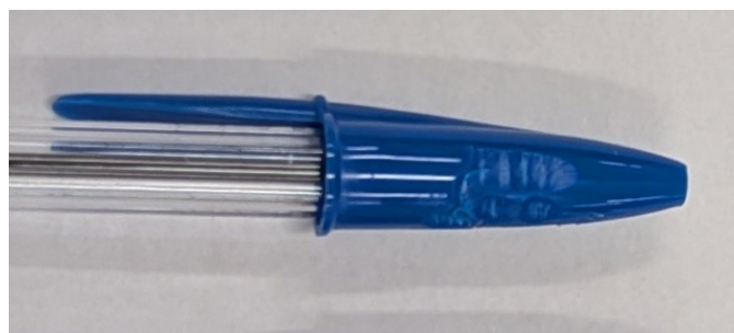
図 9. 高速メソッドおよび従来のメソッドを用いて試験したペンキャップ。写真に示すように、キャップの中間からサンプルをスライスしました。
