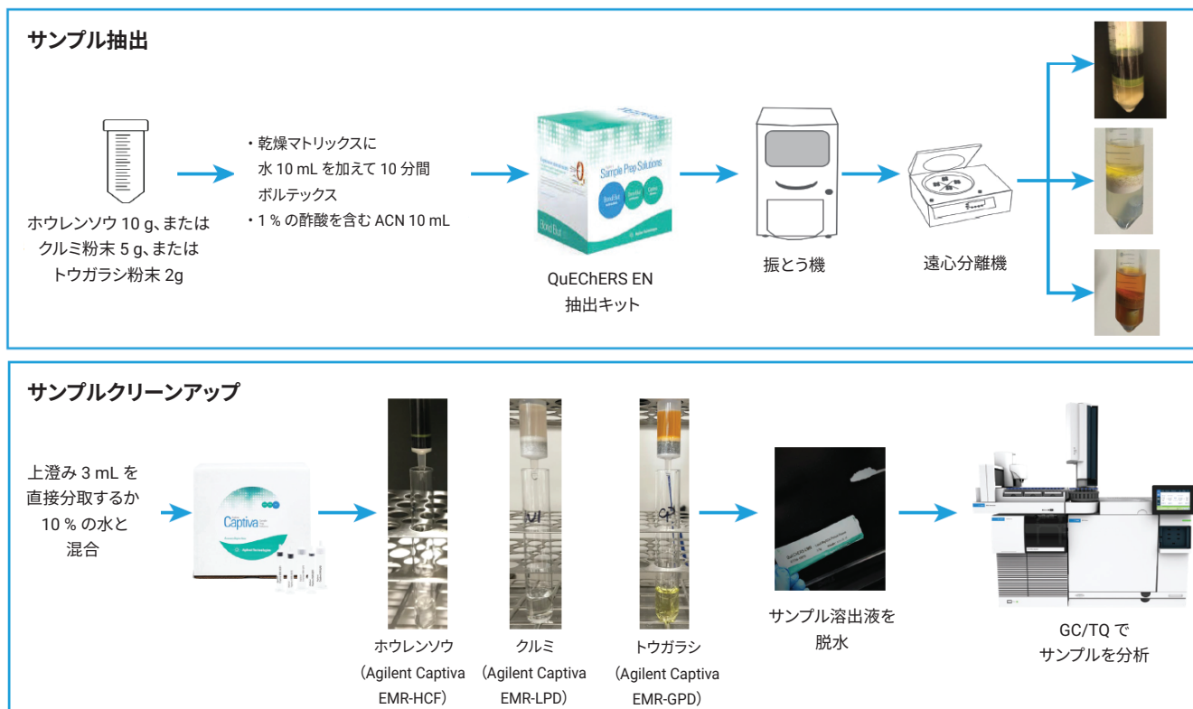
図 3. サンプル前処理フローチャート：従来の QuEChERS 抽出に続いて Captiva EMR による通液クリーンアップを実施
