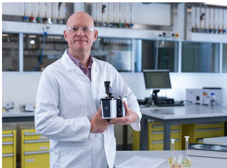
図 2. ダイヤモンド減衰全反射サンプリングモジュールを取り付けた Agilent Cary 630 FTIR 分光光度計
