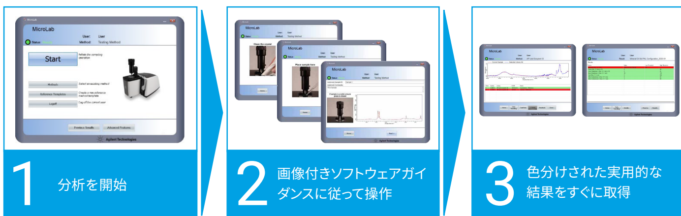
図 3. Agilent MicroLab ソフトウェアは取り付けられているサンプリングモジュールを自動的に認識して正しいパラメータを適用します。ソフトウェアが、わかりやすい画像を使用して、分析ワークフロー全体を通じてユーザーを手順ごとにガイドします。色分けされた結果は、データ取り込み後にすぐにレポートされ、短時間で直感的にデータを確認できます。
