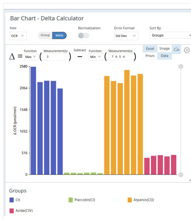
図 8. Agilent Seahorse Analytics の Bar Chart - Delta Calculator ウィジェット。ウェル全体の OCR 測定 3 – OCRmin (ロテノン) の計算が表示されています。結果の値は複合体 I 関連呼吸を表しており、Microsoft Excel や Graph Prism にエクスポートできます。
