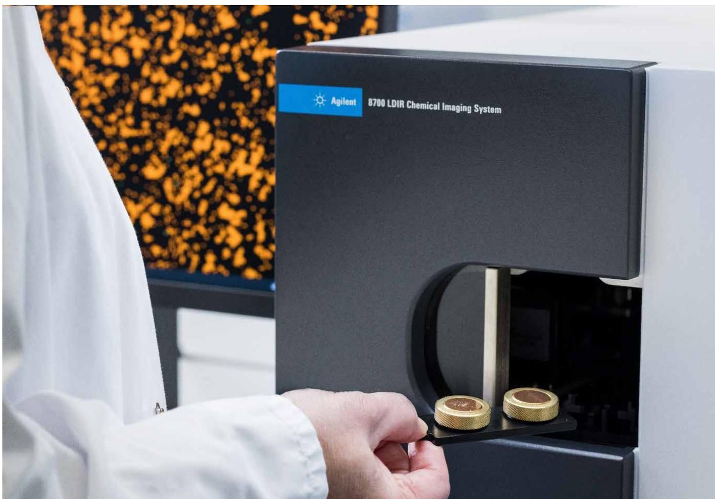
図 1. Agilent 8700 LDIR ケミカルイメージングシステム。サンプルに含まれる粒子の数、サイズ、化学組成など、マイクロプラスチックのルーチン分析を高速で実行できます。
