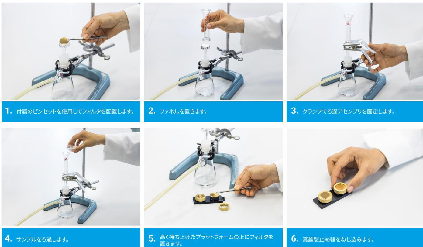
図4. LDIR オンフィルタ分析用サンプルを調製するためのサンプルろ過装置と手順
