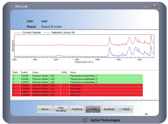
図 9. Agilent Cary 630 FTIR 分光光度計によるボトル（赤のトレース）とライブラリヒット（青のトレース）の定性分析。
