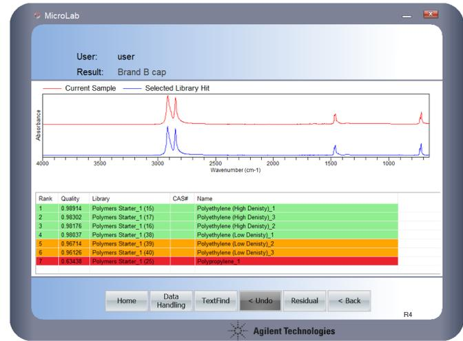
図 10. Agilent Cary 630 FTIR 分光光度計によるキャップ（赤のトレース）とライブラリヒット（青のトレース）の定性分析。
