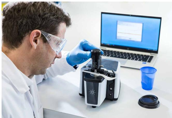
図2. ダイヤモンド ATR モジュールを搭載した Agilent Cary 630 FTIR
