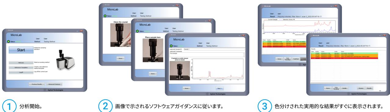
図 11. 直感的な Agilent MicroLab PC ソフトウェアのワークフローにより、Agilent Cary 630 FTIR では簡単に答えを見つけることができます。このソフトウェアは手順を画像で提供しているため、トレーニングの必要性を減らし、ユーザーベースのエラーのリスクを最小限に抑えます。
