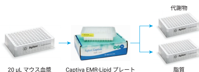
図 2. Agilent Captiva EMR-Lipid プレートを用いて、タンパク質沈殿物を除去し、充填剤上の脂質を捕捉し、極性代謝物をコレクションプレートに溶出させます。2 つ目の溶媒で脂質を別のコレクションプレートに放出することで、同一の血漿または細胞画分から極性代謝物と脂質を抽出できます。Agilent Metabolomics Bravo Sample Preparation Platform では、一体型のベンチトップアクセサリを使用して、この固相抽出を 96 ウェルプレートフォーマットで実行できます 3, 4 。
