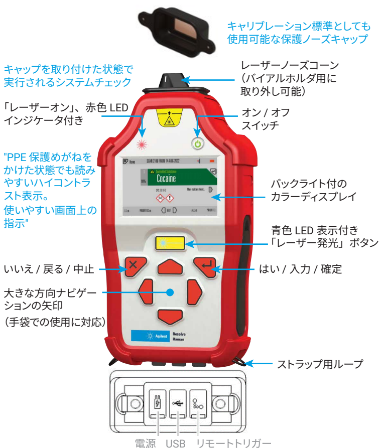
図 2. Agilent Resolve ハンドヘルド型ラマンアナライザの概略図
