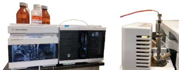
図 1. デュアル注入ニードル搭載の Agilent 1290 Infinity II マルチサンブラを用いた高速 LC メソッド
