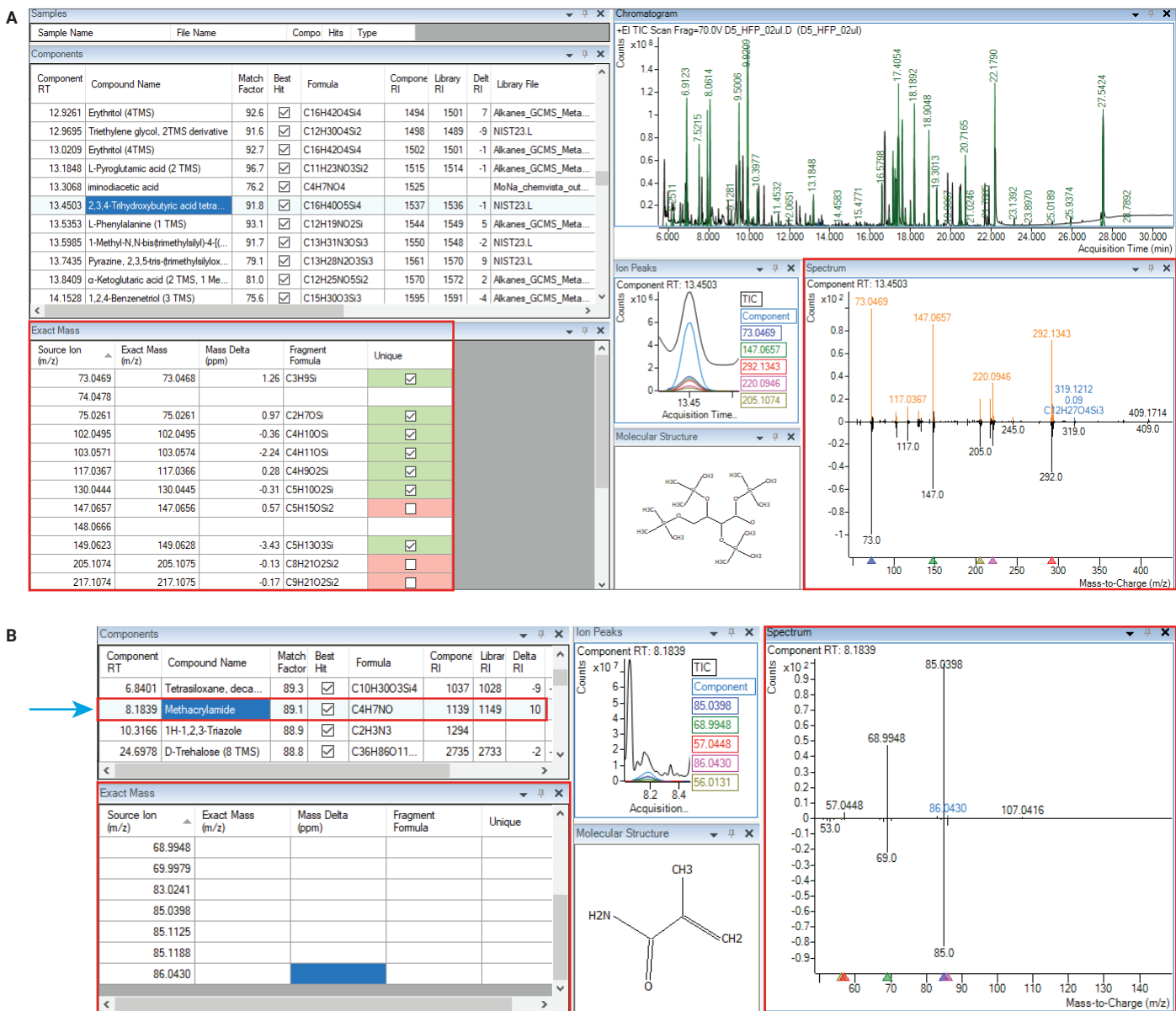
図 2. Agilent MassHunter Unknowns Analysis の ExactMass 機能を使用したユニットマスのライブラリヒットの精密質量による確認 (A) デコンボリュートした化合物の精密質量スペクトルは、NIST ライブラリヒットの式と一致分子式のサブセットに 10 ppm 以内で一致する各イオンの質量誤差が ExactMass テーブルに示されており、ミラープロット内で化合物イオンが強調表示されています。(B) 矢印は、空の ExactMass テーブルに基づいて容易に認識できる偽陽性を指し示しています。
