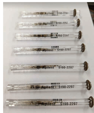
図 8. (A) ホウレンソウ抽出物で取り込んだフルスキャンクロマトグラムの TIC、および 20 ppb 農薬の MRM TIC。(B) 堅牢性評価時のホウレンソウ抽出物の分析の際に 100 回注入後に交換された GC 注入口ライナ
