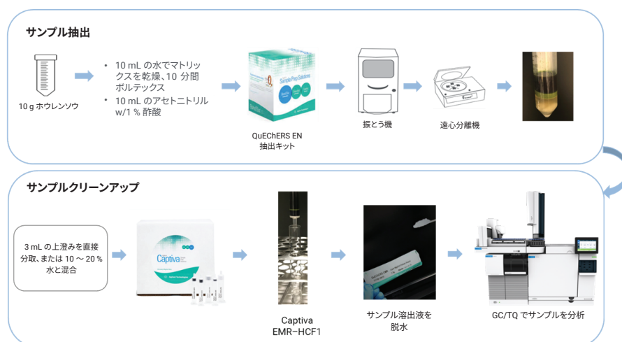
図 3. 従来の Agilent QuEChERS 抽出、その後の Agilent Captiva EMR 通液クリーンアップを含む、サンプル前処理のフローチャート
