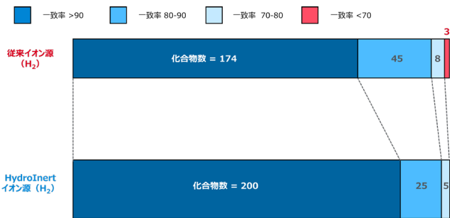
図 2. 異臭分析用データベース (He) とのマススペクトルの一致率
