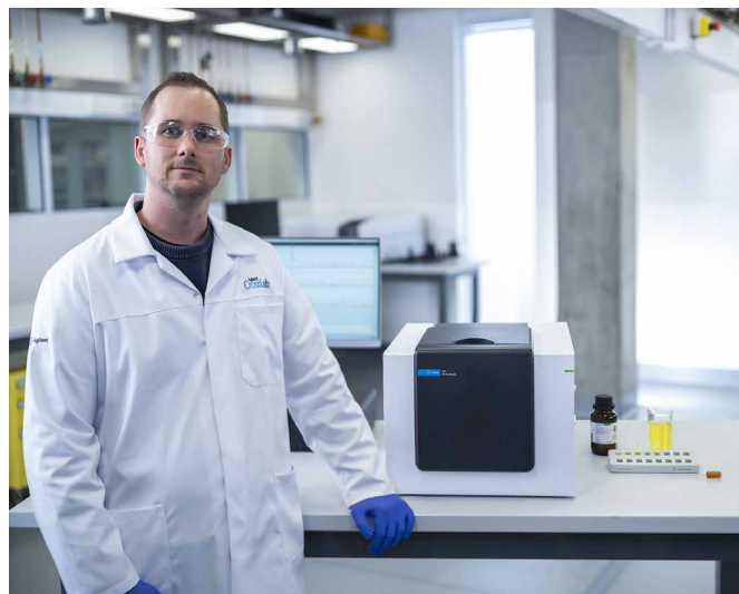
図 1. Agilent Cary 3500 フレキシブル UV-Vis 分光光度計。工具が不要の可変光路長角型および円筒型セルホルダを使用することにより、最大 10 cm までのさまざまな光路長での液体サンプル測定に対応します。
