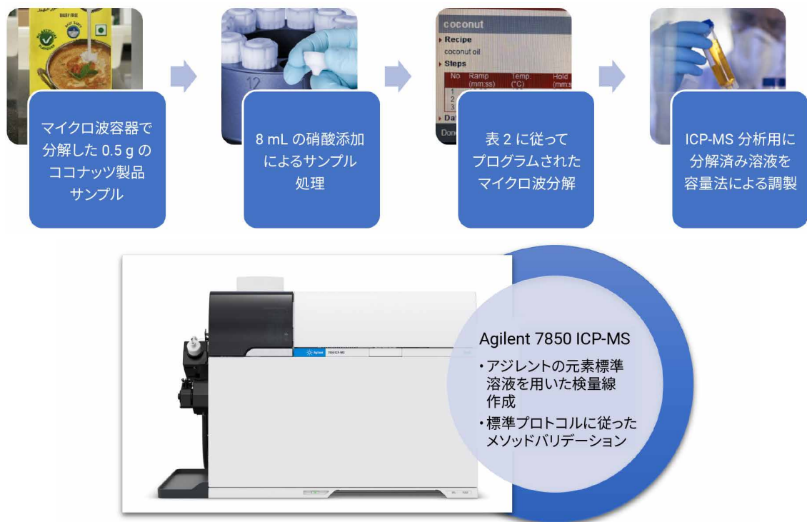
図 1. ココナッツ製品のサンプル調製と分析のワークフロー図
