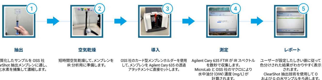
図 3. OSS 社とアジレントによる油分およびグリースの測定ワークフロー
