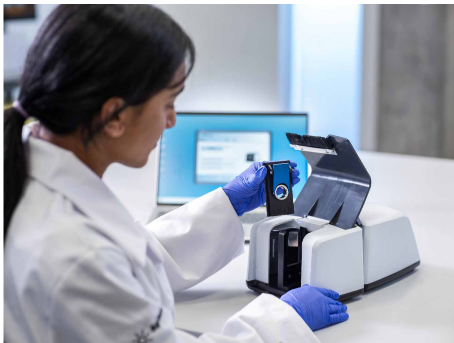
図 1. 透過アタッチメントを装着した Agilent Cary 635 FTIR 分光光度計
