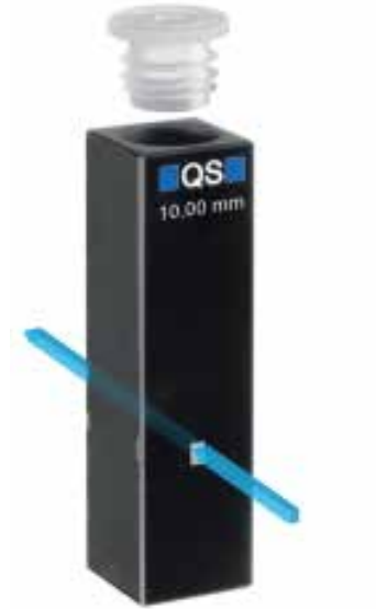
図 3. この実験で使用した Agilent ウルトラマイクロセル。Agilent Cary 3500 UV-Vis 分光光度計の非常に小さい集束度の高いビームが、調整の必要がない小型で恒久的にアライメントされた開口部を通過します。
