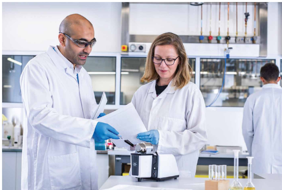
図 1. ベンチトップの Agilent Cary 630 FTIR は、用途が広く、革新的かつ直感的であり、固体、液体、気体の分析で定量情報と定性情報が得られます。
