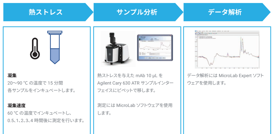
図 3. Agilent Cary 630 FTIR を使用した先発品およびバイオシミラーのリツキシマブの凝集分析用ワークフロー
