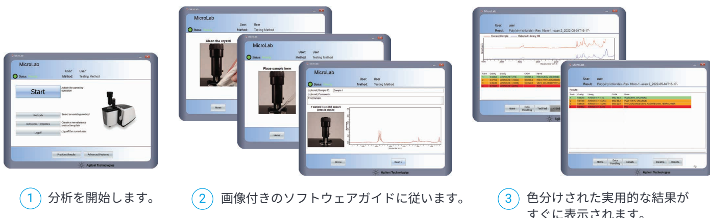
図 3. Agilent MicroLab ソフトウェアは、Agilent Cary 630 FTIR 分光光度計の操作を簡略化します。このソフトウェアは手順を画像で提供しているため、トレーニングの必要性を減らし、ユーザーベースのエラーのリスクを最小限に抑えます。
