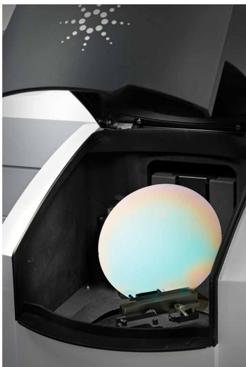
図 1. Agilent Cary 7000 UMS の測定チャンバーに直径 200 mm のシリコンウエハサンプルを取り付けた様子
