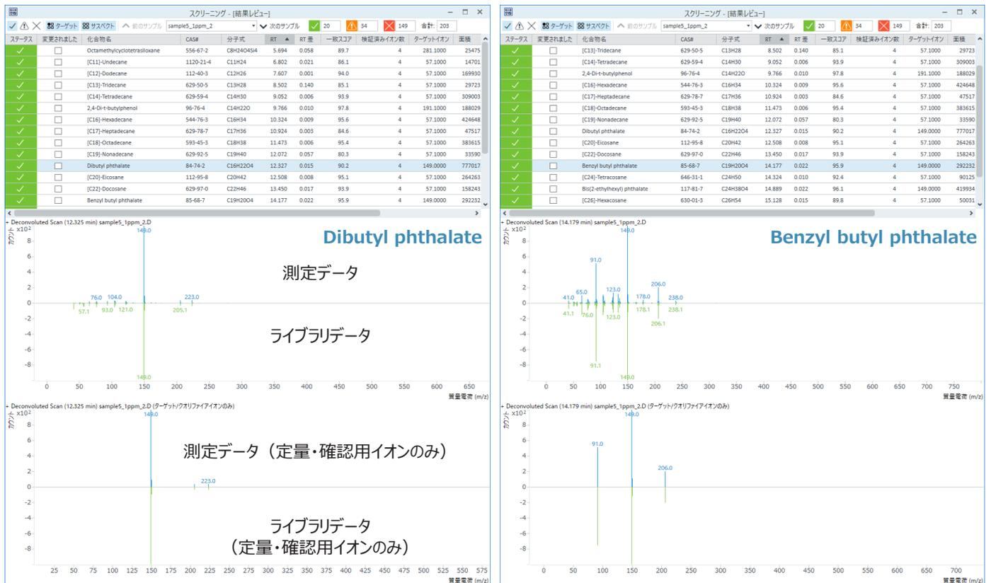
図 2. 試料 A の標準液 1 ppm 添加抽出液のスクリーニング結果。検出されたフタル酸エステル 4 化合物のマススペクトルミラープロット
