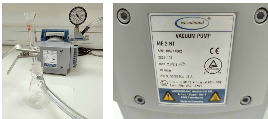
図 1. 粒子の吸引ろ過を行うために使用した真空装置。
