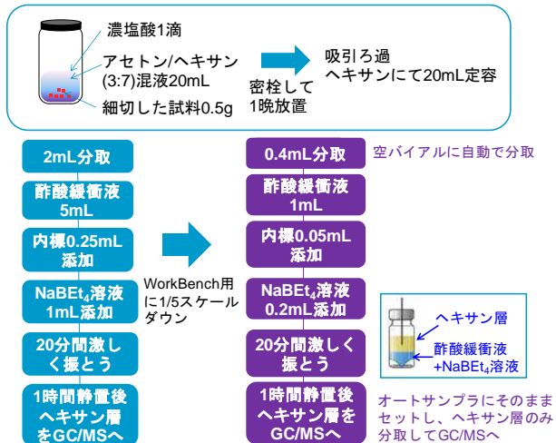
Fig.1 有機スズ前処理フローチャート
