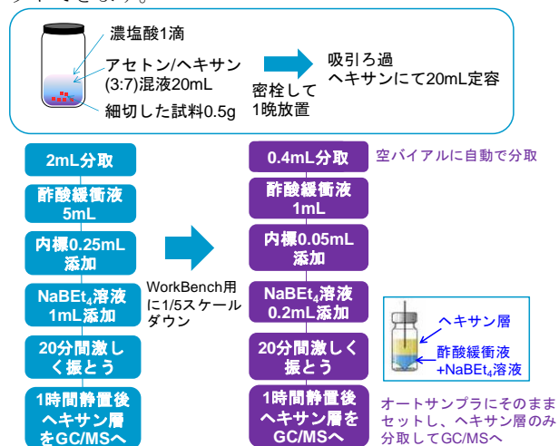
Fig.1 有機スズ前処理フローチャート
