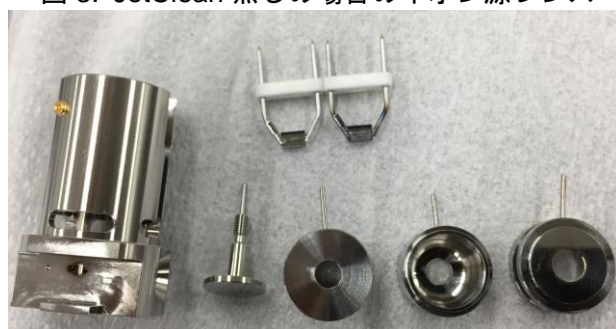
図 4. JetClean 有りの場合のイオン源の汚れ (約 350 回分析後)
