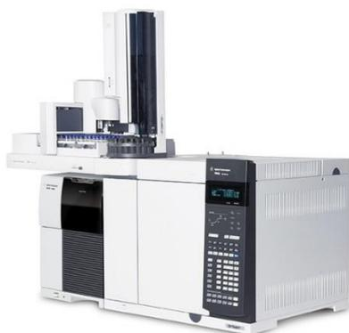
＜要旨＞ Agilent GC/MS クマリンアナライザにより、燃料油中のクマリンを前処理なしで直接分析する手法を確立しました。クマリン標準液の分析結果より、検出下限値は 0.01 mg/L (ppm) 以下であると算出され、1 サンプル 5 分以内に分析することができました。また、同時に炭化水素の分布を観察することが可能でした。
