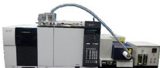
＜要旨＞ Agilent 7890A GC/5977B MSD をリガク社製示差熱天秤 TG 8121 と接続し、同時測定が可能な装置を構築しました。示差熱天秤から直接 MS に導入するダイレクトモードと、冷却トラップ後 GC/MS 測定が可能なトラップモードがあります。示差熱天秤測定により発生したガスを (GC/MS) で測定することにより、マスクロマトグラムによる各化合物の温度プロファイル、マススペクトルによる化合物情報を得ることができます。
