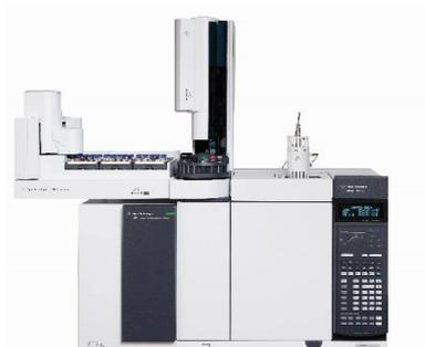
＜要旨＞ 化学発光硫黄検出器(SCD)を使って絶縁油に含まれる腐食性成分であるジベンジルジスルフィド(DBDS)の定量を行いました。GCの選択型検出器のひとつである化学発光硫黄検出器(SCD)は硫黄化合物に対して最も高い感度と選択性を持ち、広範囲な濃度の硫黄分を検出することができました。
