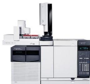
＜要旨＞ 2013年4月に新たに水道管理項目の農薬類の分類の見直しと、新たな標準検査法が設定されました。新規規制農薬を含むすべての農薬で、標準溶液5ppbの検出が可能で、繰り返し再現性も134成分中130農薬で10%未満でした。
