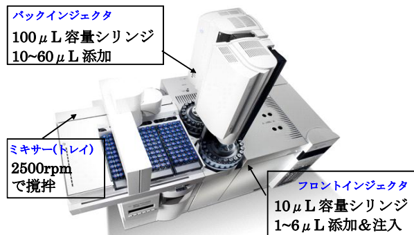
Fig.1 オートサンプラの構成
