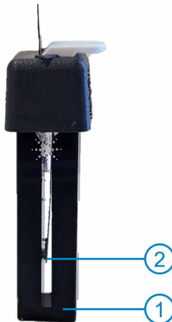
図 2. 測定中に実験温度を制御するために使用したアジレントのセミマイクロセル (1) とキュベット内温度プローブ (2)
