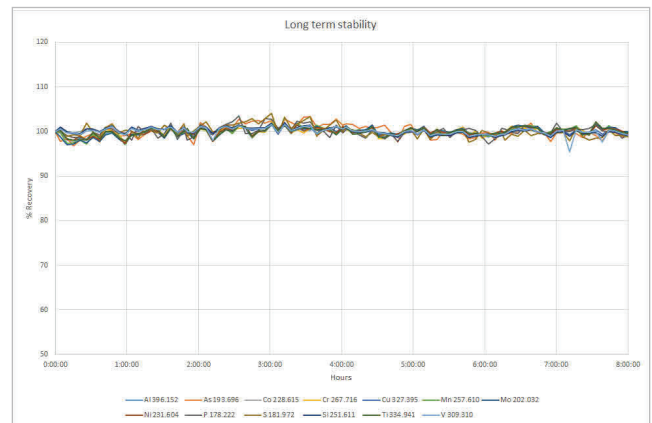
図 4. 8 時間にわたる鋼サンプルの連続分析の長期安定性プロット
