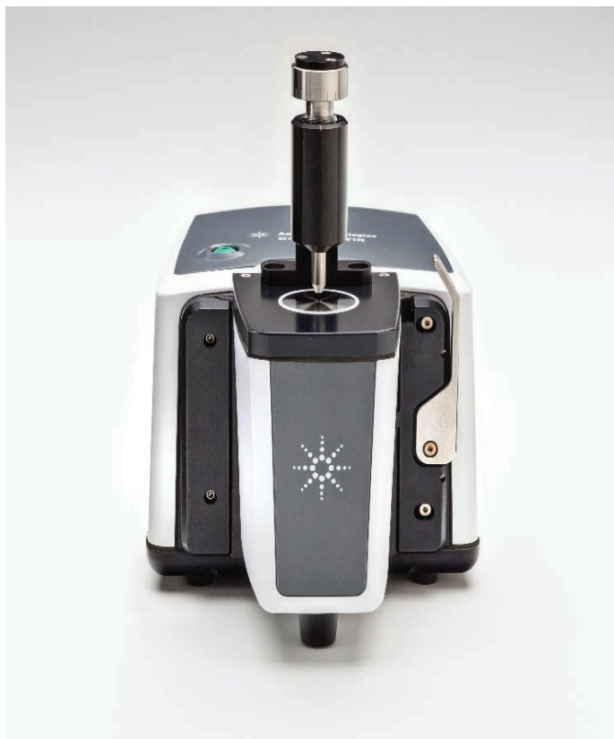
図 1. ATR サンプリングアクセサリを装着した Agilent Cary 630 FTIR
