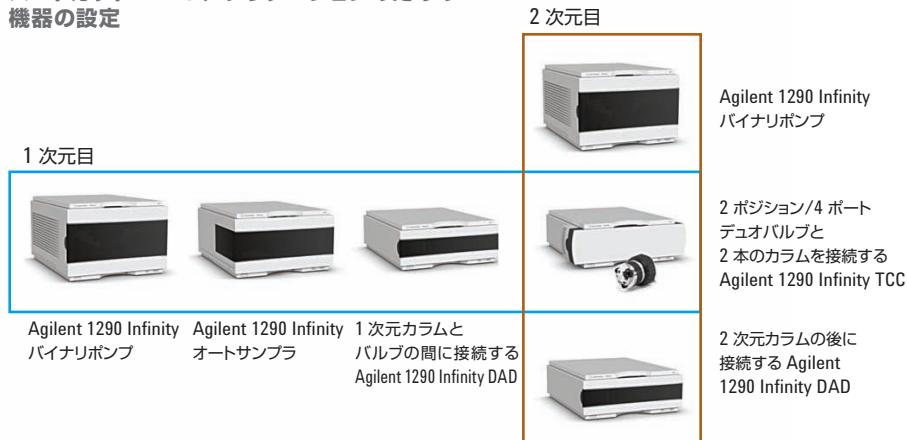
この構成では、1 次元目と 2 次元目に同じポンプを提示しています。一般的に、2 次元目では高速グラジエントを適用することから、2 次元目のポンプは 1290 Infinity ポンプでなければなりません。1 次元目のポンプには選択の余地があり、1260/1290 Infinity クォータナリポンプまたは 1260 Infinity バイナリポンプにすることもできます。詳細については、アジレント文献 5991-0834EN をご覧ください。
