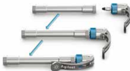
A-Line クイックコネクTFitting は、 手締めで接続した後、レバーを閉じることで 1300 Bar まで使用可能です。
