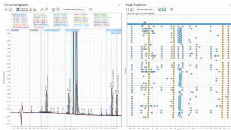
図1. クロマトグラム表示(左側)とピークエクスプローラ表示(右側)の比較
